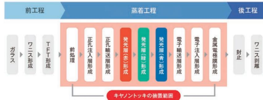
主な技術として、①内部が非常にクリーンで高真空な環境の真空容器を製作する技術、②ガラス基板を高速・高精度で搬送するFA(ファクトリーオートメーション)技術、③発光層がガラス基板に付着する位置を高精度で制御する成膜・アライメント技術などが挙げられます。これらの全てにおいて、当社には長年の装置開発による技術ノウハウの蓄積があります。そして、パネル量産装置を安定して提供してきた豊富な実績も有しています。
