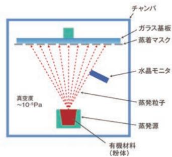
RGBの発光色を得るには、ホスト材料に数%程度の微量な色素材料をドーピング(添加)します。これは2種類の有機材料を同時に蒸着させ、基板上で混合膜を形成するもので、共蒸着と呼ばれています。
